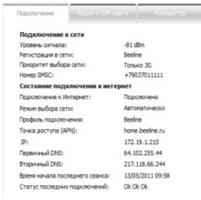
Рисунок 2. Уровень сигнала на модеме Билайн без использования «Connect»
